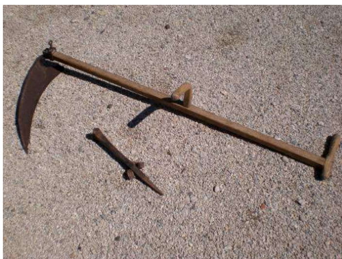
Une faux ( dâlye en patois) composée d'un manche ( folchier en patois) et d'une lame 1 .
